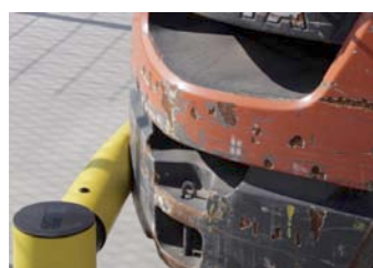
Barreira absorve energia do impacto
