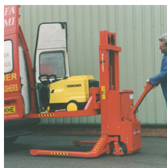
Na elevação e transporte de equipamento para uma viatura
