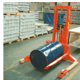
Movimentação de bidões metálicos
